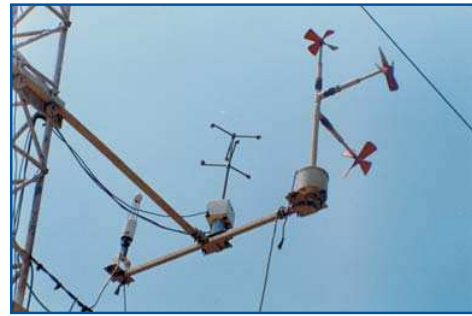
आरमेक्स - फेज-II के दौरान एनसीएओआर, गोवा में सोनिक एनिमोमीटर तथा CO_2/H_2O एनालायजर सिस्टम की प्रयोगात्मक स्थापना
