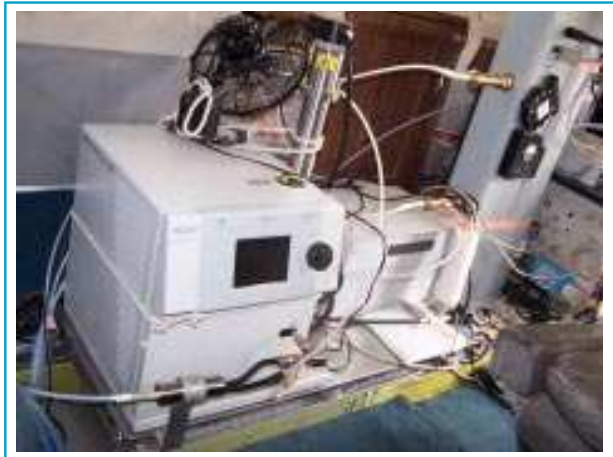
ICARB अभियान के दौरान इस्तमाल किया गया क्रमविक्षण सचलता धुलिकण मापन उपकरण (SMPS)
